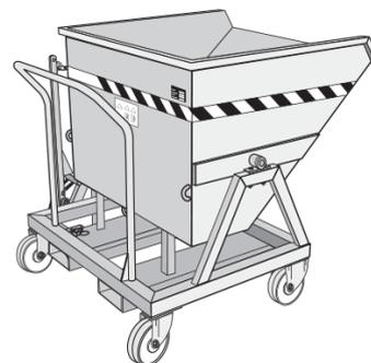
b) Con comando manuale e ribaltamento controllato del cassone, valido per i contenitori e benne portarottami ribaltabili, ma non applicabile ai modelli LT 450- LT 460 - LT 470. Con questa configurazione l'attrezzatura è completa di impianto idraulico autonomo, costituito da un cilindro idraulico a doppio effetto, autofrenante con compensatore di flusso (fig. 1.2).
