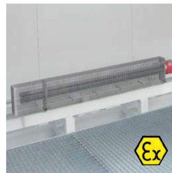
Riscaldatore elettrico ATEX tipo di protezione: antideflagrante/EXPLOSION PROOF Eexd-II C-T2. Grado di protezione: IP65.
