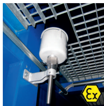
Termostato per la rilevazione e regolazione della temperatura in ambienti con pericolo di esplosione o con atmosfera fortemente aggressiva. Tipo di protezione: II 2 GD Ex d IIC T6-Ex tD A21. Grado di protezione: IP66/67.
